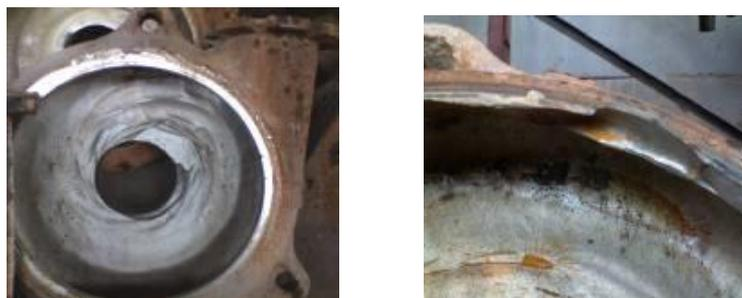
Рисунок 2.6 – Износ корпуса грунтового насоса 8Гр-8
