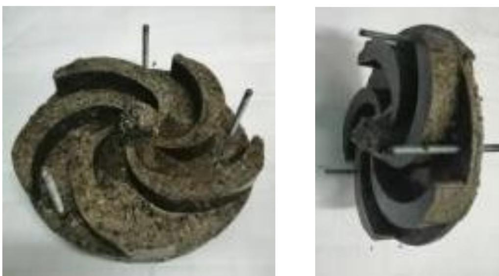
Рисунок 3.7– Рабочее колесо насоса облицованное полимербетоном
