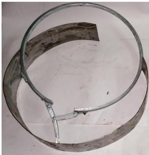
Рисунок 3.2 – Обечайка с быстроразъемным хомутом.
