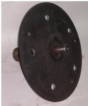
Рисунок 3.4 – Узел базирования формы.
