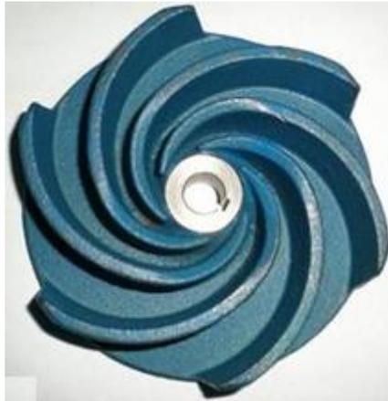
Рисунок – Рабочее колесо открытого типа
